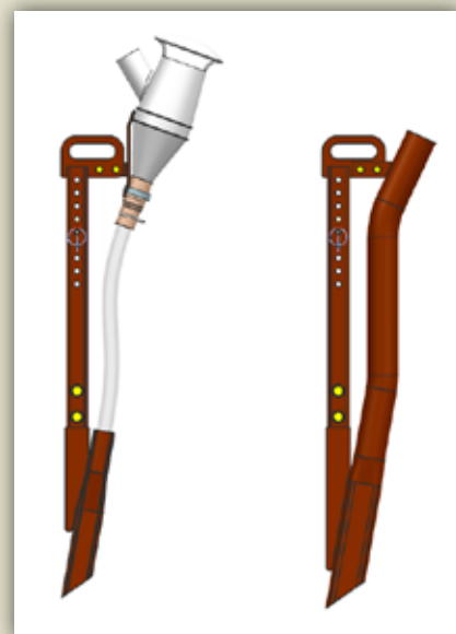
Dostępne są dwa rodzaje redlic nawozowych, które mają możliwość pracy na max. głębokość 20 cm. Mniejsza z nich jest używana dla granulowanych nawozów mineralnych, natomiast większa (60 mm) służy do aplikacji gnojowicy.
