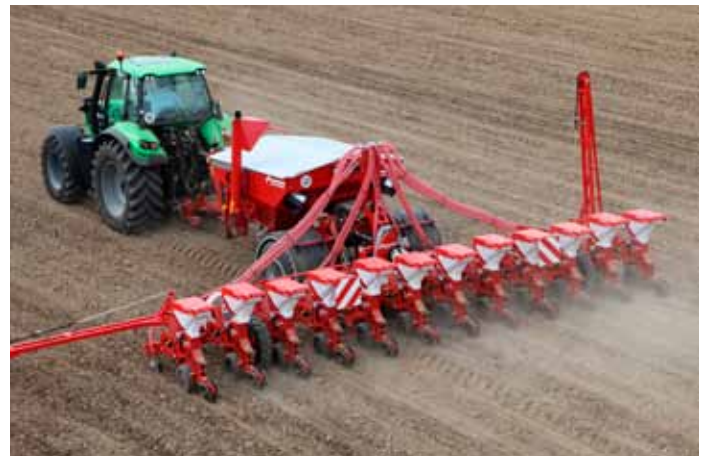
FlexCart + Optima e-drive 12 rzędów z ramą składaną hydraulicznie PH 9.0 m
