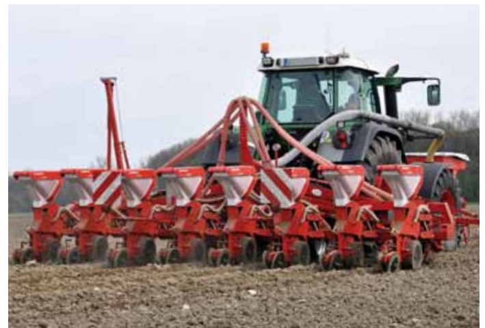
OPTIMA - 8 rzędów, rama składana hydraulicznie PH 6.0 m, nawożenie w połączeniu z DF-1 ze zbiornikiem o pojemności 1150 l
