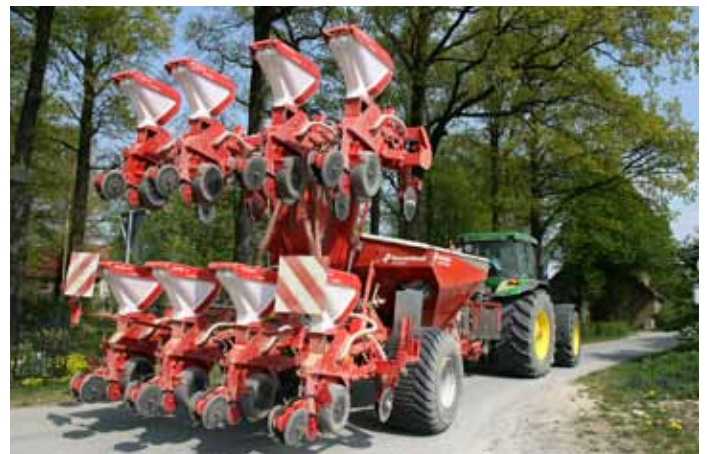
FlexCart + Optima e-drive 8 rzędów z ramą składaną hydraulicznie PH 6.0 m w pozycji transportowej
