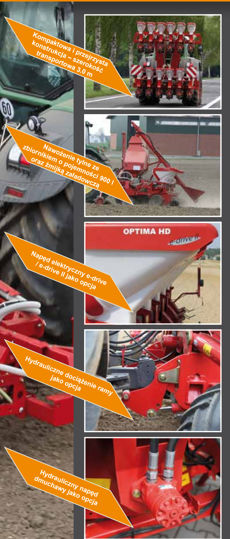
OPTIMA - 8 rzędów, rama składana hydraulicznie PH 6.0 m, nawożenie w połączeniu z DF-1 ze zbiornikiem o pojemności 1150 l
