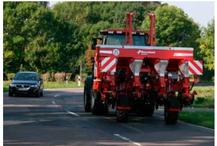
OPTIMA TFprofi - 8 rzędów z ramą ciąganą składaną hydraulicznie 6.0 m w pozycji transportowej
